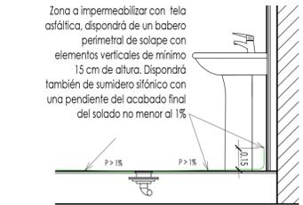
**A08 SECCIÓN DETALLE DE IMPERMEABILIZACIÓN**
